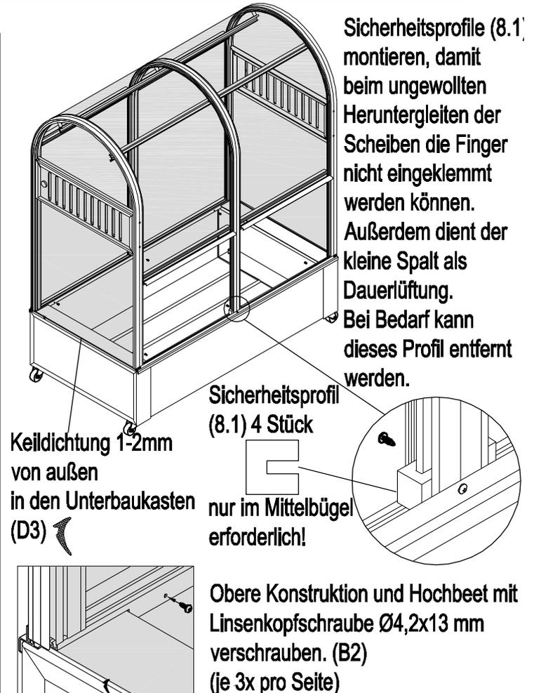
Sicherheitsprofile (8.1) montieren, damit beim ungewollten Heruntergleiten der Scheiben die Finger nicht eingeklemmt werden können. Außerdem dient der kleine Spalt als Dauerlüftung. Bei Bedarf kann dieses Profil entfernt werden.
