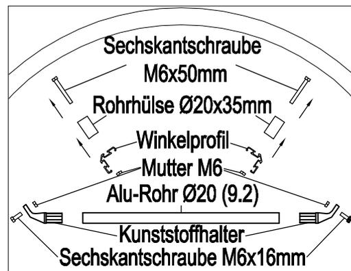
Die Winkelprofile werden mit einer Sechskantschraube M6x50 mm und einer Rohrhülse verschraubt. Der Kopf der Schraube wird in den Profilkanal eingeführt und in die richtige Position gebracht. (B2) (je 3x pro Seite). Das Alu-Rohr Ø20 mit den Kunststoffhaltern (9.2) wird mit einer Sechskantschraube M6x16mm und einer M6 Mutter an den Winkelprofilen befestigt. (B3)
