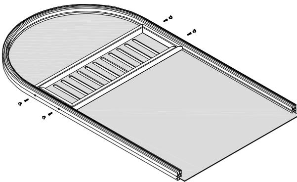
Schiebelüfter mit Linsenkopfschraube  $\text{Ø}4,2 \times 22$  mm verschrauben. (B1) Die verbleibenden Sacklöcher anschließend mit den Blindstopfen 10mm verschließen (je 2x pro Seite).
