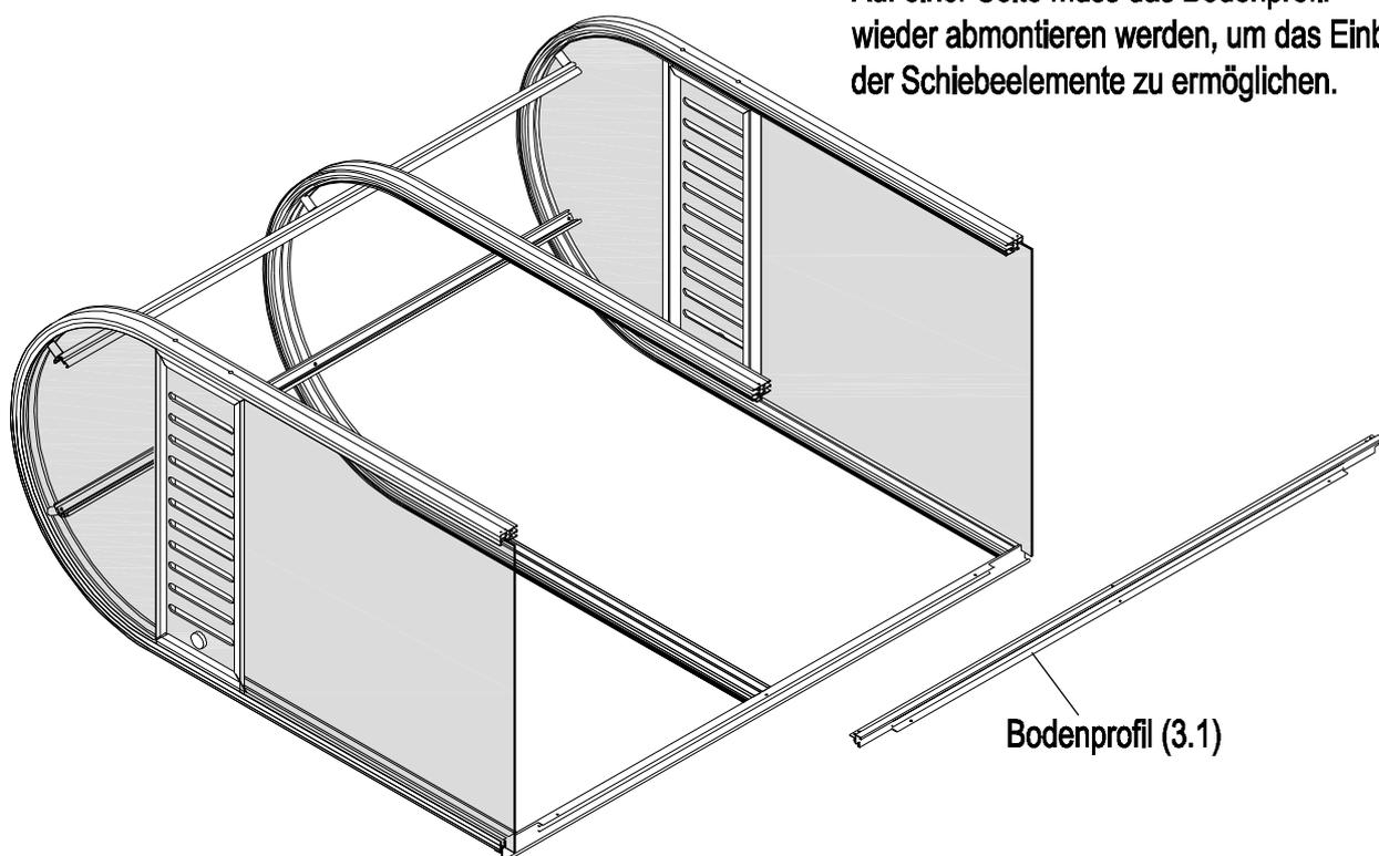
**Achtung:** Bitte beachten Sie genau, welches Schiebeelement in welchen Profilkanal geschoben wird. Für die problemlose Umsetzung dieser Arbeit sollte zwingend eine 2. Person helfend zur Verfügung stehen, um das "Einfädeln" der Schiebeelemente zu vereinfachen.
